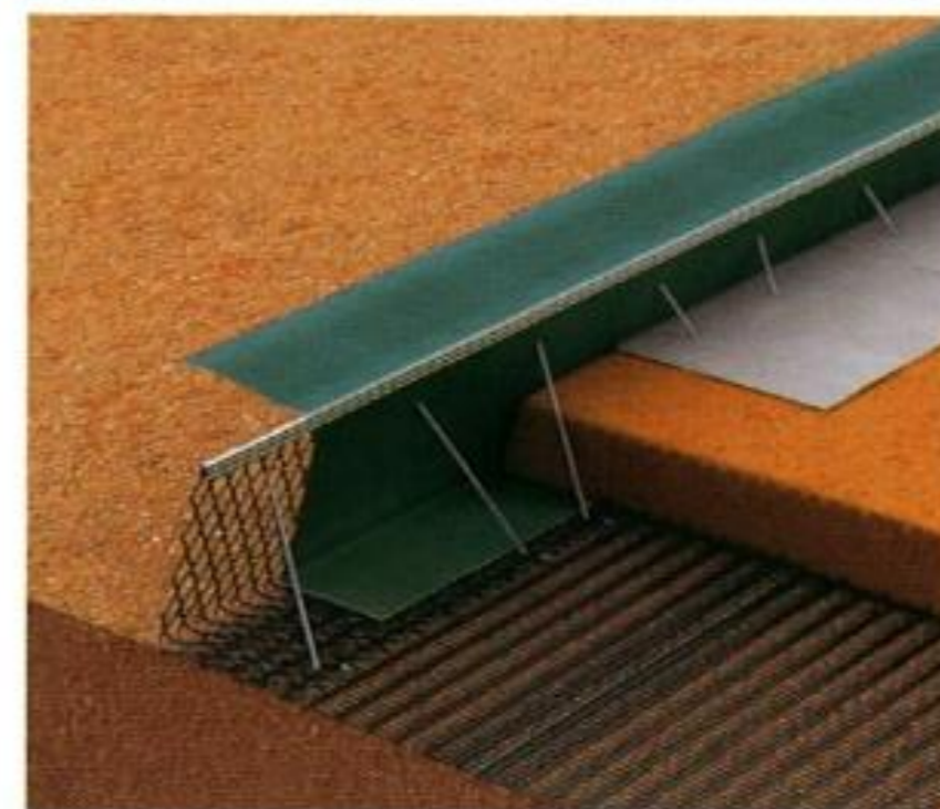
3 敷均し・締固めと層厚管理材の敷設
