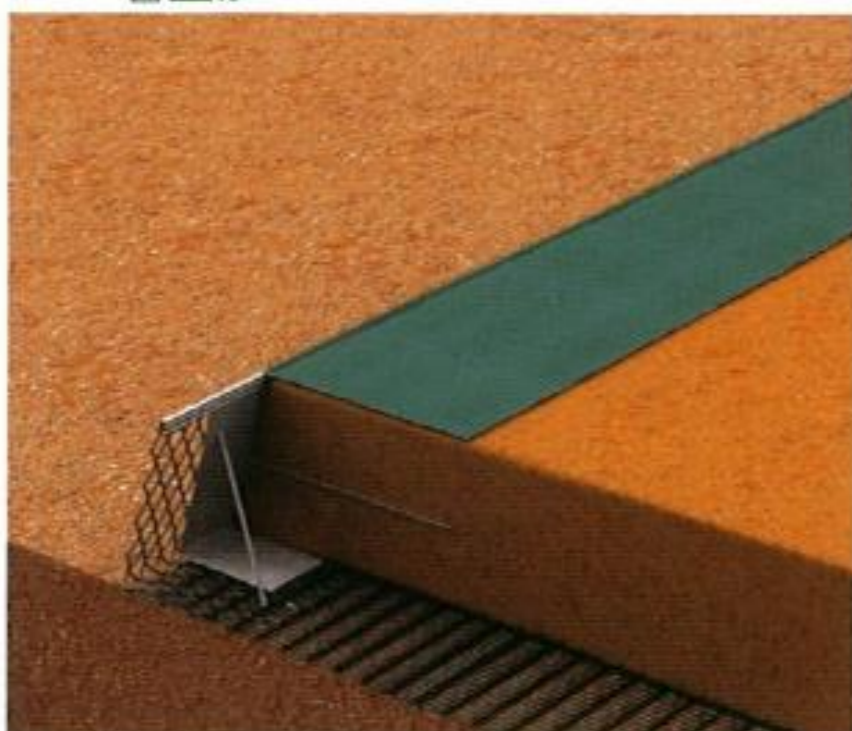
4 補強拘束ネット付植生シートの 巻上げ
