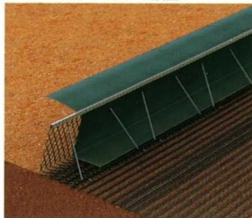
2 補強拘束ネット付植生シートと ユニットキャップの設置
