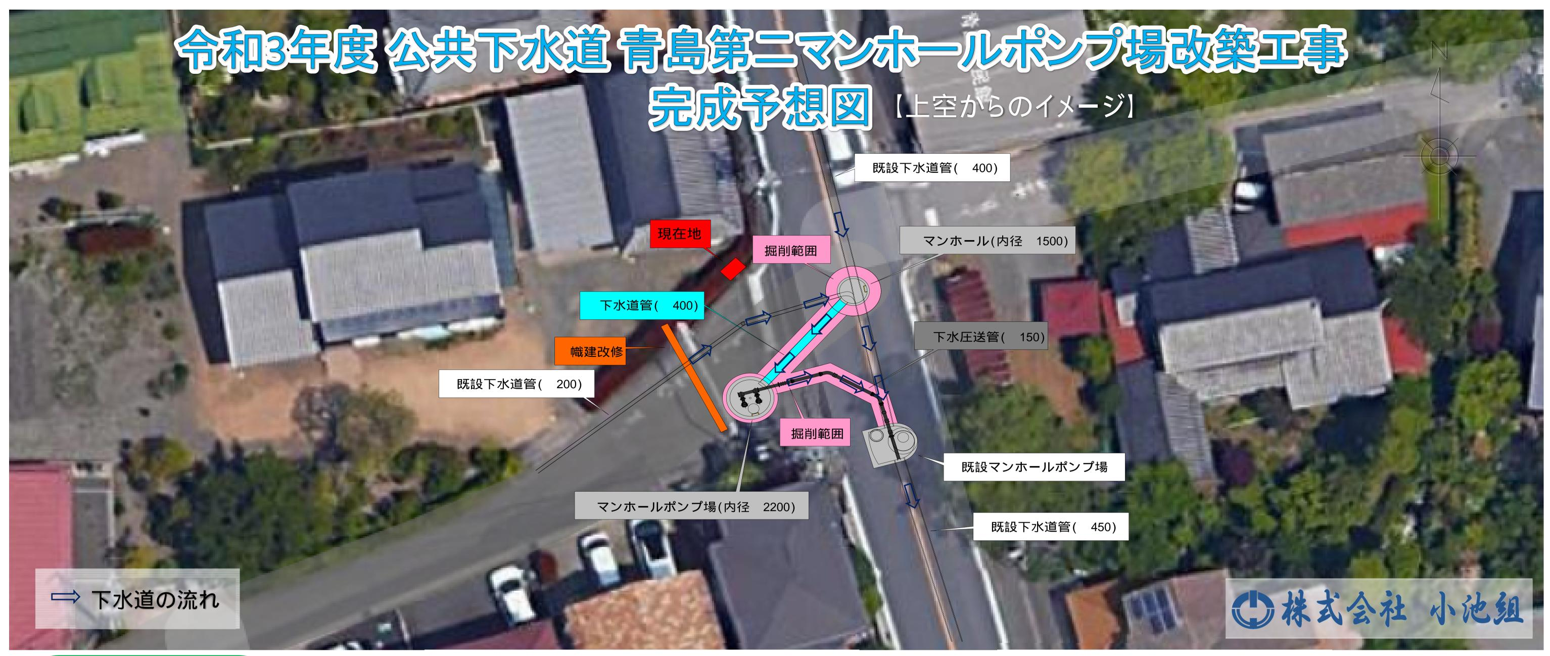
既設のマンホールポンプ場の老朽化のため、新たに2マンホールポンプ場設置 1マンホール改修をする工事です。
